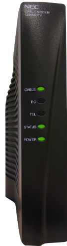
前面 (正常時のランプ状態)
