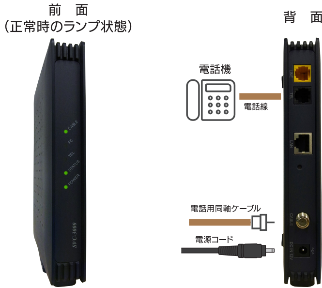
外形寸法：横30mm×高さ184mm×奥行159.5mm ※突起物をのぞく
