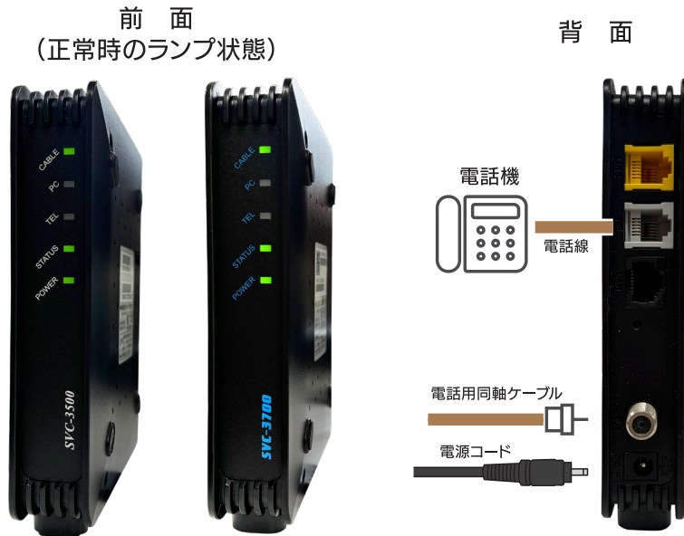
外形寸法：横31.7mm×高さ148.2mm×奥行120mm ※突起物をのぞく
